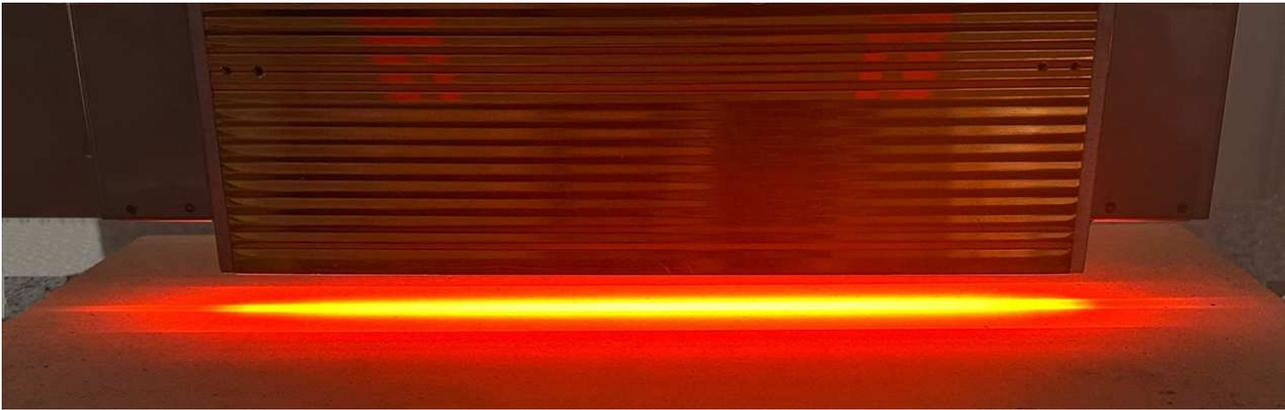
Bata tahan api disinari dengan HLH-55W/f25/L280 dari jarak pengenal 25mm.
