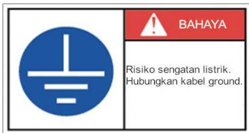
3)Pastikan untuk selalu menghubungkan bagian perangkat seperti bodi tungku atau bingkai dengan sistem grounding.
