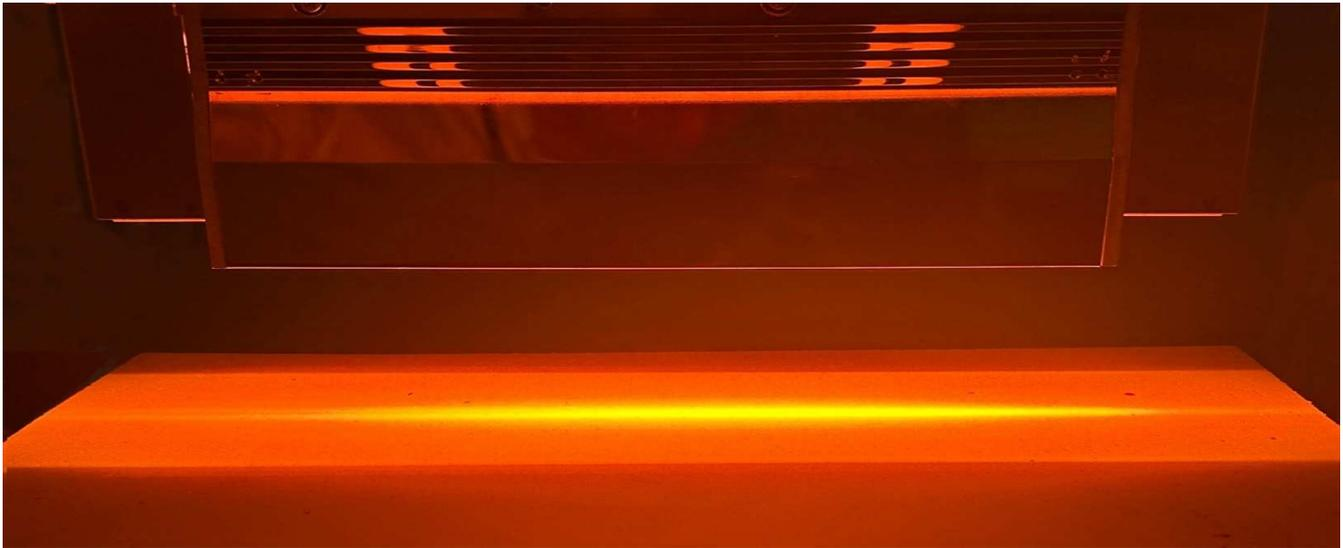
Bata tahan api disinari dengan HLH-65W/f75/L280 dari jarak pengenal 75mm.
